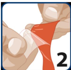
Remova e descarte o filme de separação transparente. Fita térmica funciona em ambos os lados.
