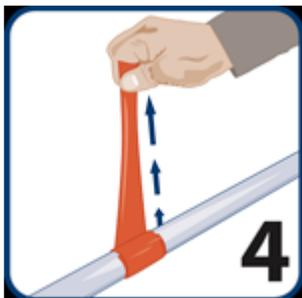
Mantenha um alongamento constante à medida que continua a enrolar, certificando-se de que cada nova camada "dê meia volta" na camada anterior. Essas sobreposições se fundirão.
