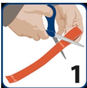
Limpe a superfície que será embrulhada e corte o comprimento da fita a ser usada.
