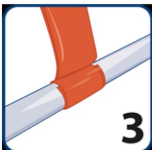
Segure uma extremidade da fita térmica na posição contra o objeto a ser enrolado e aplique um enrolamento completo ao redor do objeto e de volta a ele. Esse invólucro inicial protege a fita para envolvimentos adicionais.
