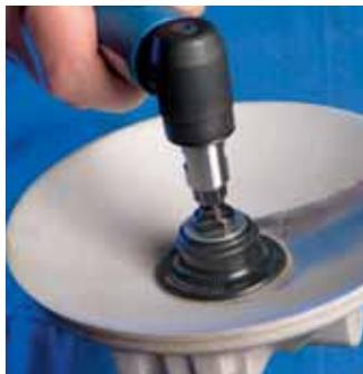
Las herramientas **ATADISC®** convencen por sus portadiscos ligeros que se montan por módulos y que por ello, son especialmente económicos. El sistema de fijación de metal-plástico tipo bayoneta garantiza un cambio rápido de herramienta "con un solo toque".
