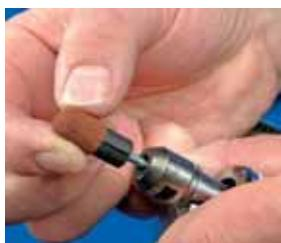
Las herramientas **POLICAP®** se utilizan especialmente en matrizería para realizar trabajos de acabado en puntos difícilmente accesibles. Son adecuadas para el mecanizado de acero y acero inoxidable. El dedil lijador sin costura se coloca sobre el portadediles. Los dediles quedan sujetos al portadediles gracias a la fuerza centrífuga. Fácil cambio de la herramienta.
