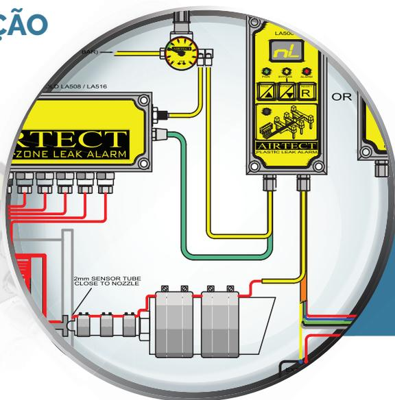
SISTEMA DE ALARME PARA BICO DE INJEÇÃO E DISTRIBUIDOR ATÉ 32 ZONAS
