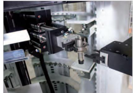
Parallelgreifer zur Handhabung von Werkzeugaufnahmen,
