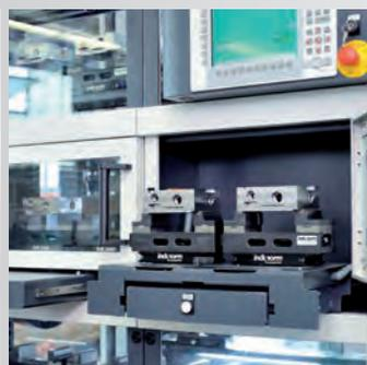
Ein- und Auslagerungsstation zum hauptzeitparallelen Bestücken
