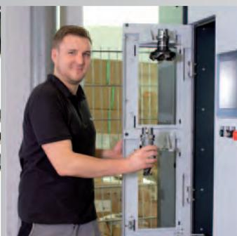
Beladen des ToolChangers mit einem Werkzeug
