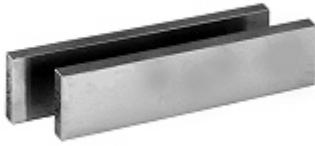
Pares rectificadas en planoparalelo. Datos sobre el tamaño en la parte frontal del producto. Los juegos suministran una amplia gama con 1mm de graduación. Templado por cementación. Tolerancia del par tp en la altura IT 5. Tolerancia de la medida nominal en la altura y anchura según DIN ISO 2768m. Medida restante según DIN ISO 2768m.
