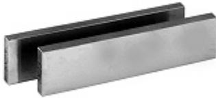
Pares rectificadas en planoparalelo. Datos sobre el tamaño en la parte frontal del producto. Los juegos suministran una amplia gama con 1mm de graduación. Templado por cementación. Tolerancia del par tp en la altura IT 5. Tolerancia de la medida nominal en la altura  $\pm 0,01$  mm. Medida restante según DIN ISO 2768m.
