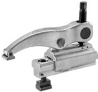
completo con fijación Robusto elemento de fijación de acero aleado bonificado en serie forjada para alturas de sujeción variables y con elemento base desplazable. Consta de: - Elemento base - Elemento de soporte - Pieza de presión con superficie lisa - Juego de fijación n° 7500BF
